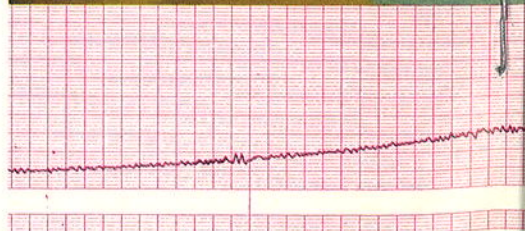
Grafico delle variazioni del Cx (coefficiente di penetrazione nell'aria) in funzione del cambiamento d'assetto dello sciatore.
