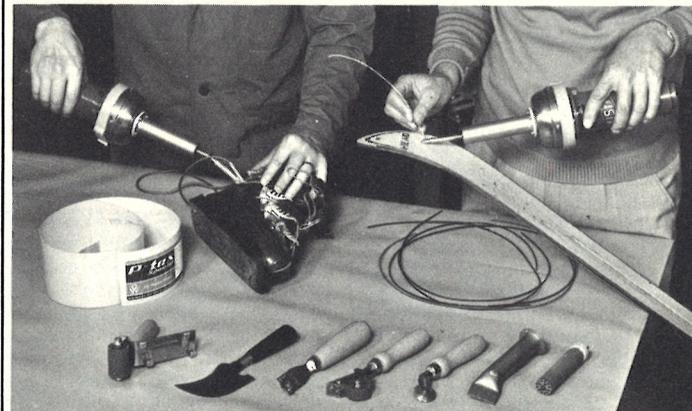
Riparazione di uno scarpone e della soletta di uno sci con l'apparecchio Leister Kombi n. 1 e ugello rapido n. 27
